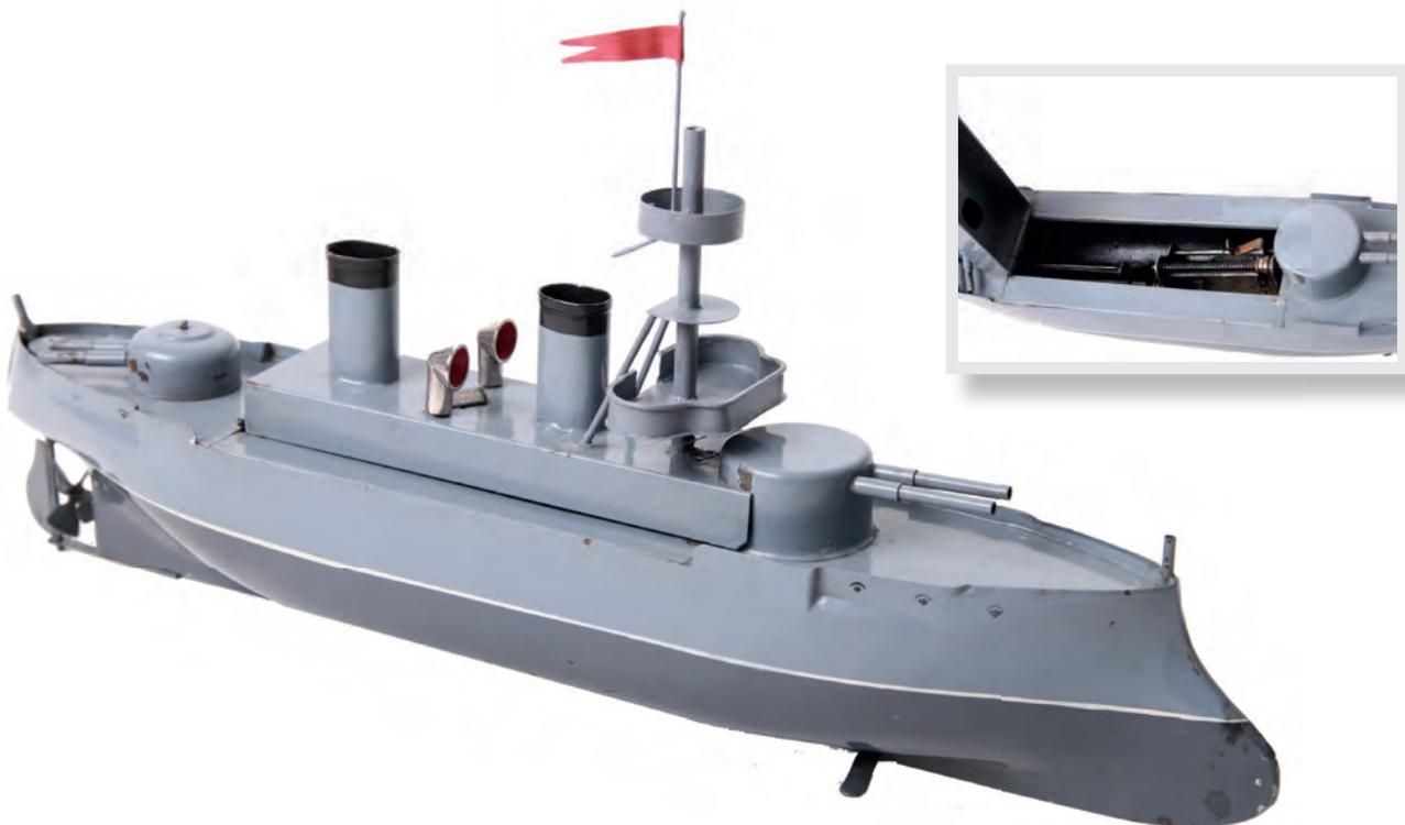
**3016** Bing 155/382 Panzerschiff Kanonenboot mit funktionierendem Uhrwerk, mit automatisch schießender Kanone. Die Kanone wird vorgespannt und bei Auslösen des Schusses wird die Stellung des Ruderblattes verändert und somit die Bewegungsrichtung des Schiffes. L40cm, Z2-
