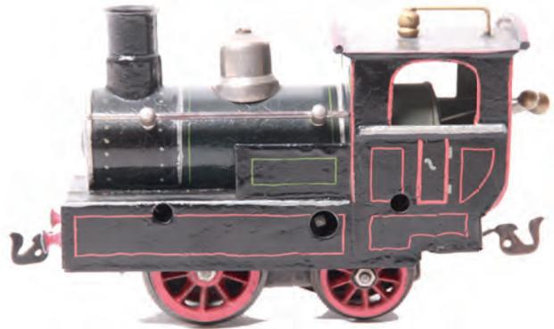
**8079** Märklin S 0, Zahnrad Dampflok ca. 1902 mit funktionierendem Uhrwerk, vor- und rückwärts fahrend mit Bremse, kleine farbliche Ausbesserungen. L17 Z2- € 950,00
