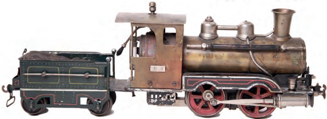
**8168** Märklin S 1, E4021 „B1“ Spiritus Dampflok B, mit Tender, frühe Ausführung von 1902 mit Holzgriffen und erster Drehschiebersteuerung, L43cm, Z2+ € 1.900,00
