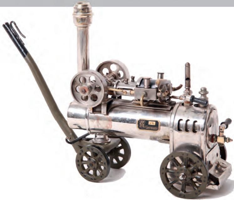
**8141** Märklin,, 4801 Miniatur fahrbares Lokomobile „Lilliput“. Vollständig aus Messing hergestellt, Compound Hoch-und Niederdruckzylinder, doppelt wirkend, Sicherheitsventil und Dampfpeife, mit Spiritusbrenner, selten, 19x8x17cm, Z1- € 800,00
