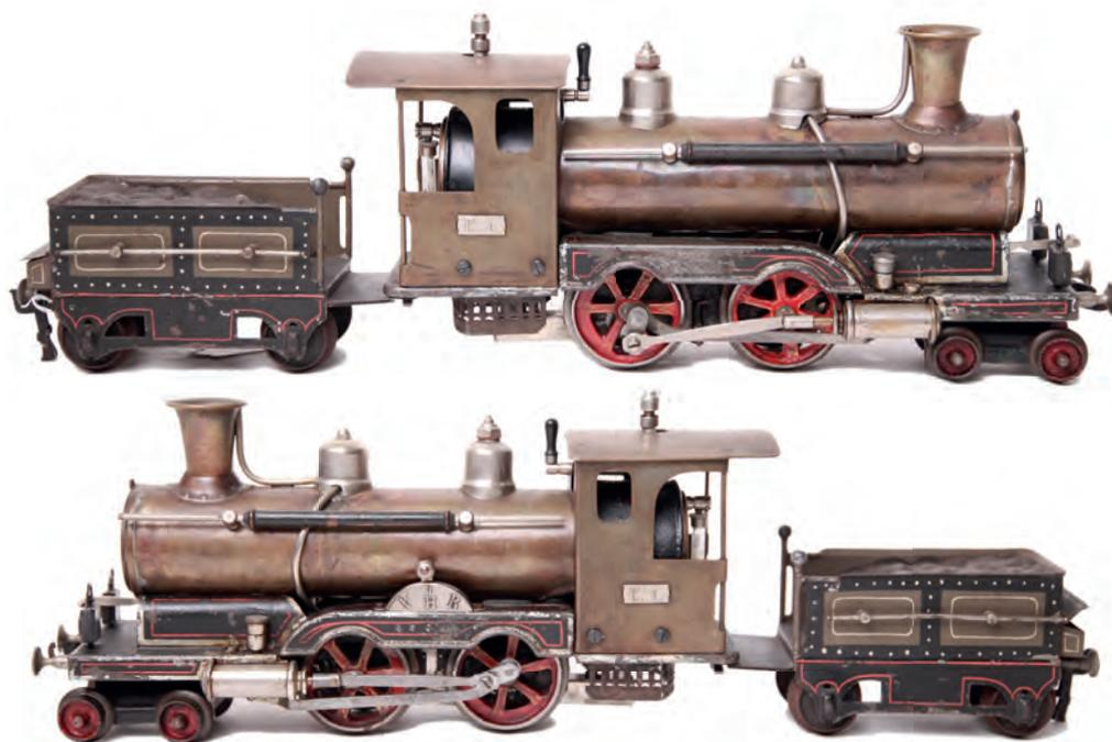
**8167** Märklin S 1, E4021 ‚E1‘ Spiritus Dampflok 2B, mit Tender, frühe Ausführung von 1902 mit Holzgriffen und erster Drehschiebersteuerung, L48, Z2+ € 2.800,00
