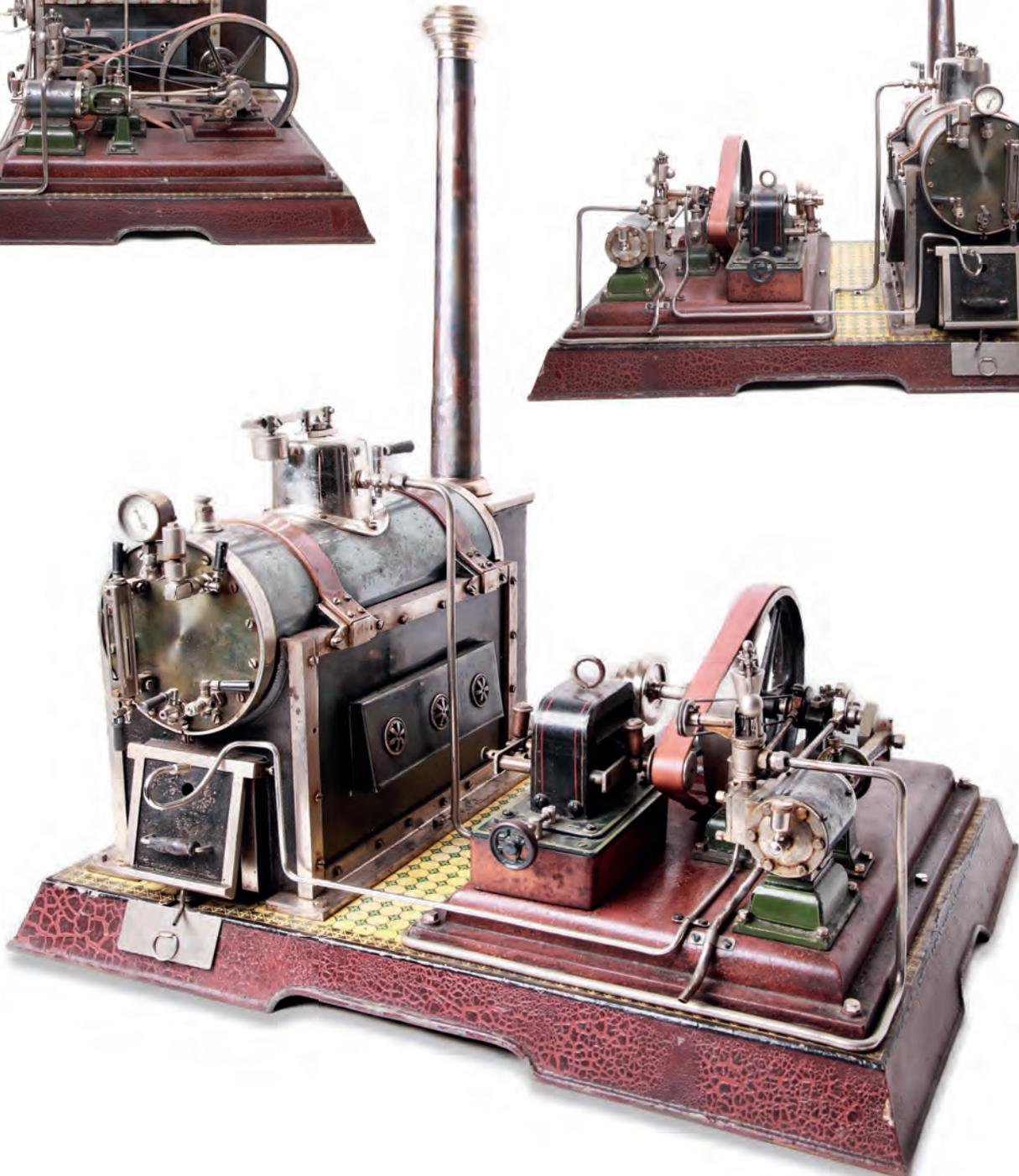
**8029** Märklin, 4163/11/ N 94 Hochdruck-Dampfanlage mit Zirkulationsheizung und Hochdruckkessel, gleicher Kessel wie an stehender 2-Zylinder Ventil-Maschine. Die Feuergase umströmen den gesamten Umfang des Kessels innerhalb des Isoliermantels. Verschiebbarer Dynamo, funktionierender Fliehkraftregulator mit Dynamo. Eine seltene Maschine. 3394/1 12W L47x61x67cm Z1- € 9.500,00
