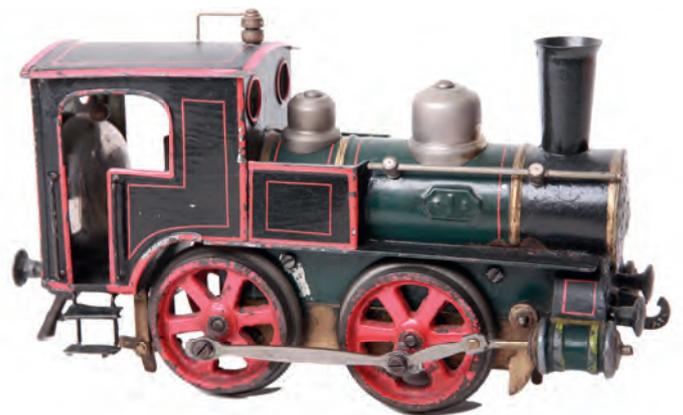
**8169** Märklin S 1, T1021 Klingel-Lok, erste Ausführung um 1903 mit Schild am Kessel. Mit funktionierendem Uhrwerk und Klingel. Sehr selten. L22cm, Z1-2 € 3.800,00
