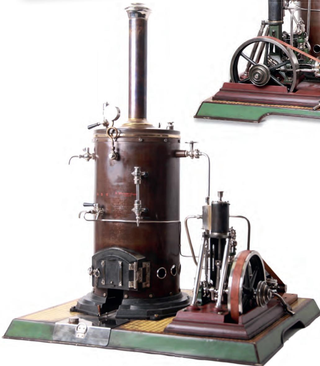
**3530** Märklin, 4126/25/3395 (4143) Extra grosse Dampfmaschine, sog. ‚Winkelcompound‘. Stehender Kessel mit 8 vertikalen Heizröhren. 9 Liter Inhalt. Verbundmaschine mit horizontal und vertikal arbeitenden Zylindern.
