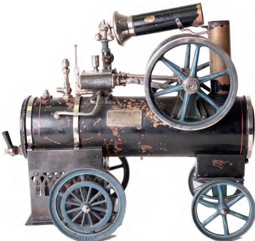
**8142** Märklin,4154/7 Dampf-Lokomobil von 1902, fahrbar. Eine seltene Verbundmaschine mit 2 feststehenden Hoch- und Niederdruckzylinder, Brenner und Wasserstandsglas fehlen. L28cm, Z2 € 3.500,00
