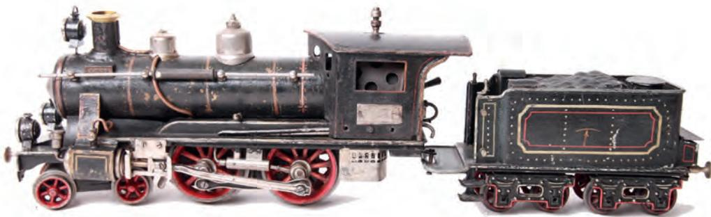
**8205** Märklin S 1, FE4021 Spiritus Echtdampftrieb, mit 4-achsigem Tender, frühe Ausführung der FE, mit wasserführendem Tender und Speisepumpe an Lok angebaut, Manometer lose. Brenner fehlt. L60cm, bespielt Z2-3 € 1.400,00
